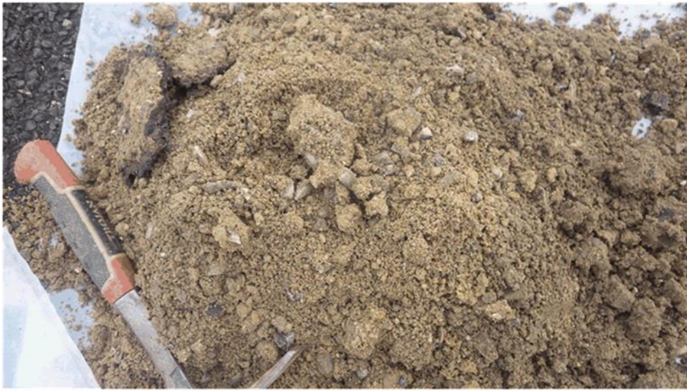
BH08 – Granular base layer
